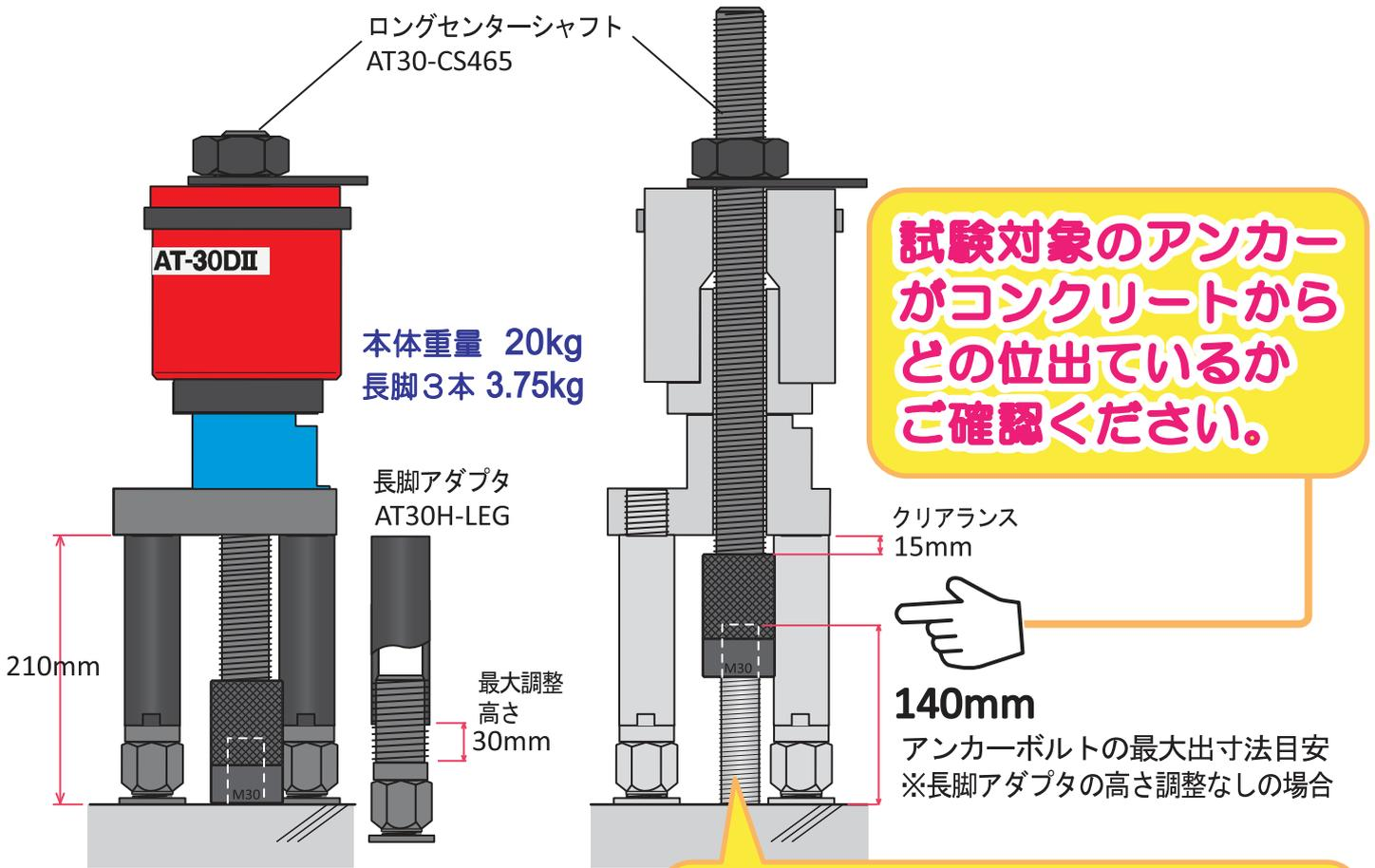
アンカーボルトの出が短くカップリングがコンクリートに接する取付け状況
